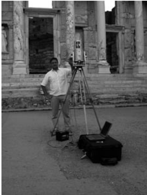
1 3-D-Laserscanner RIEGL LMS-Z210 im Einsatz vor der Celsusbibliothek in Ephesos, Herbst 2002
