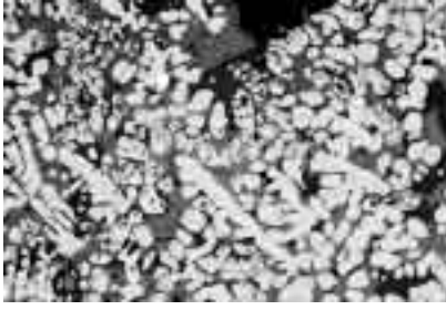
Abb. 29: Schlackenklotz FK2000/D: Bereiche mit über 50% Fe: Wüstit (hell). V = 100 x [OB16-13].
