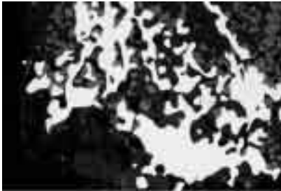
Abb. 32: Schlackenklotz FK2000/D: „Eisenschwamm“. V = 100 x [OB17-1].
