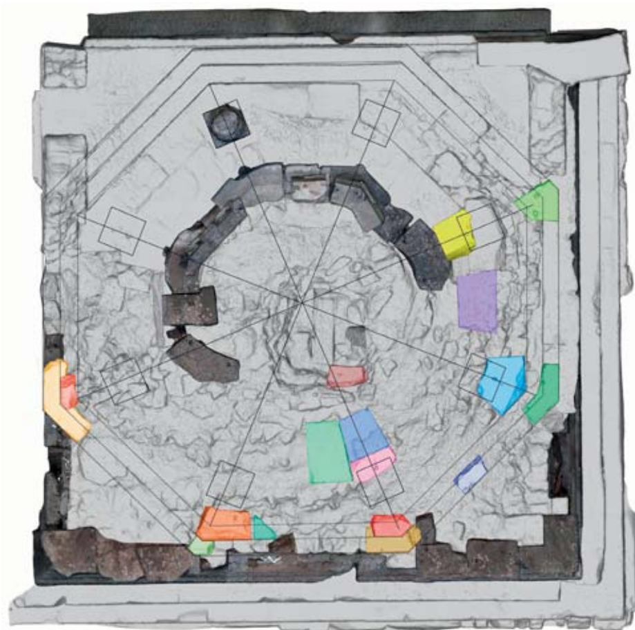
Abb. 12: Zusammenfügen von Bauteilen mithilfe der zweidimensionalen Orthoansichten
