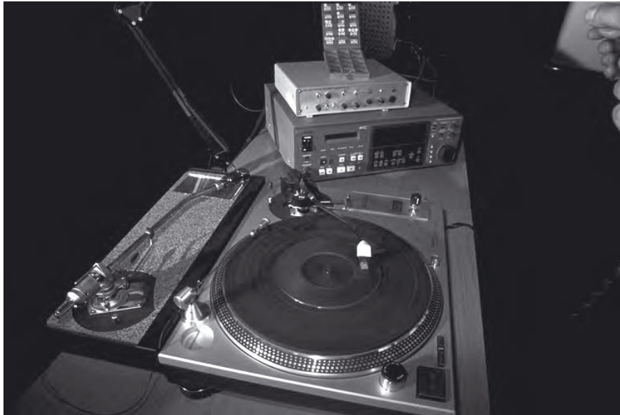
Abb. 113: Überspielstation für Phonogramme: Diapason Archiv-Plattenspieler, im Phonogrammarchiv entwickelter Vorverstärker/Audio Heritage PA-02, Spezialnadeln von Expert-Stylus
