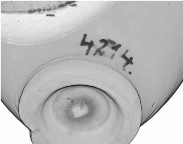
Abb. 6: Mit Zinkweiß geschriebene Inventarnummer des proto- korinthischen Aryballos CT01184 (UMJ Inv.-Nr. 4214) mit deutlich sichtbarem Dichteunterschied; VRVis Volume Renderer (Visualisierung ÖGI, D. Habe)
