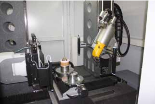
Abb. 3: Aufnahme im Inneren der CT-Anlage v|tome|x C 240 D: in der Bildmitte Drehteller mit einem darauf positionierten Keramikgefäß (CT04136, KFUG Inv.-Nr. G 26) im Strahlengang, rechts Röntgenröhre und links Detektor (Foto D. Jungblut)
