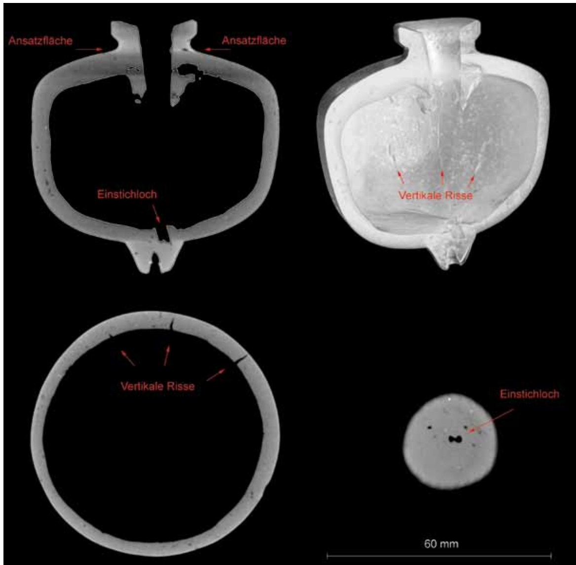
Abb. 33: Ostgriechisches Granatapfelgefäß CT03047 (KFUG Inv.-Nr. G 56) mit Spuren der Herstellungstechnik wahrscheinlich in einer Negativform; VG Studio MAX und VRVis Volume Renderer (Grafik S. Karl; Visualisierung ÖGI, J. Rosc)
