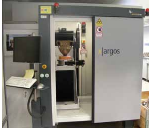
Abb. 16: Kolonettenkrater (UMJ Inv.-Nr. 4613) in der Computertomografieanlage x|argos|compact am Gießerei-Institut Leoben (Foto S. Karl)
