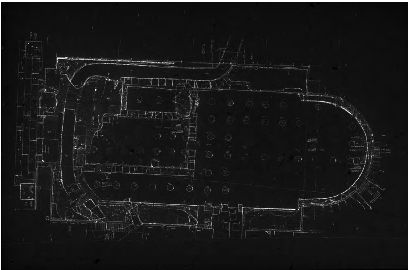
Abb. 25: Apsidensaal 8, Dokumentation von Boden mit Hypokaustum
