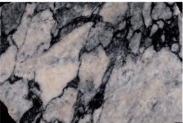
21- Bigio Antico Herkunft: Kleinasien, Westanatolien Verwendung: Fußbodenplatte
