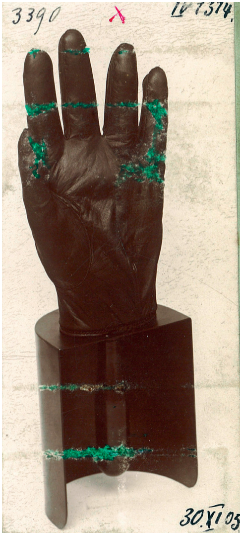
Abb. 1: Modellhand für Röntgen-Messzwecke, 1905. Quelle: Siemens Healthineers MedArchiv.
