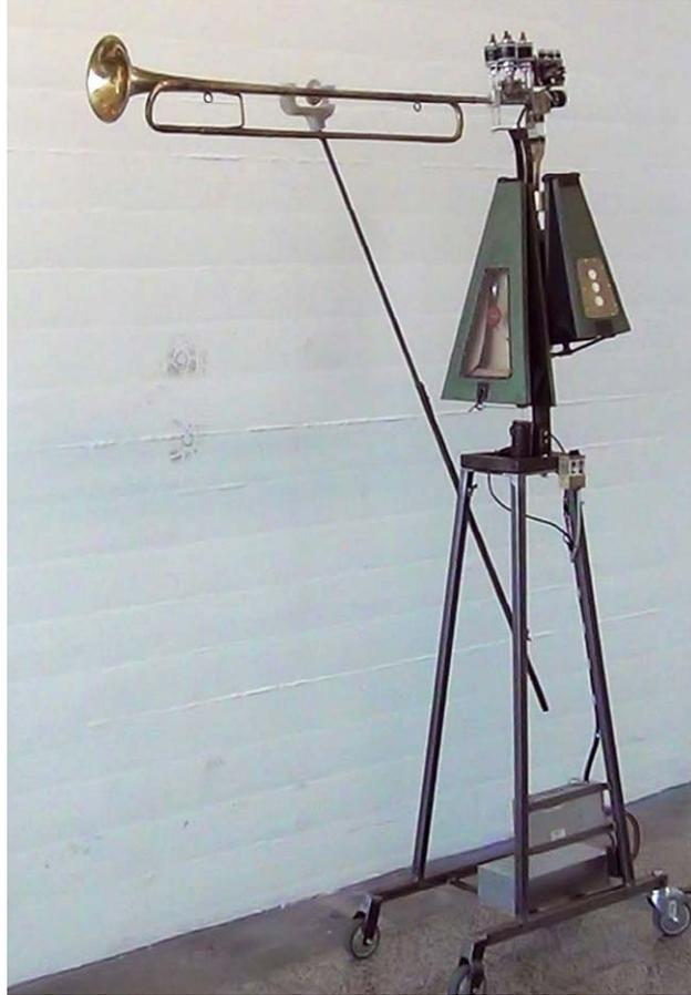
Abb. 1: Der Nachbau des Mälzel'schen Trompeters von Jakob Scheid (Universität für angewandte Kunst Wien). Die Tonproduktion und die Windversorgung entsprechen dem historischen Vorbild, die Bewegungen des Mechanismus werden jedoch mittels Elektromagneten bewerkstelligt, das Gerät wird mit Batterie betrieben. Auf eine Nachbildung der figürlichen Hülle wurde verzichtet. Die MIDI-Files mit der rekonstruierten Musik werden von einer Speicherkarte gelesen (Foto: Franz Pavuza, Phonogrammarchiv der ÖAW)
