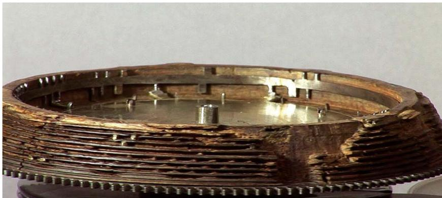
Abb. 3a: Der Informationsträger des Trompeterautomaten von 1582: ein hölzernes Rad mit zehn Spuren für die zehn Töne des Regals, die Abfolge der Trommelschläge ist als Zahnkranz (innen liegender Metallreifen) kodiert (Foto: F. Pavuza, Phonogrammarchiv ÖAW)
