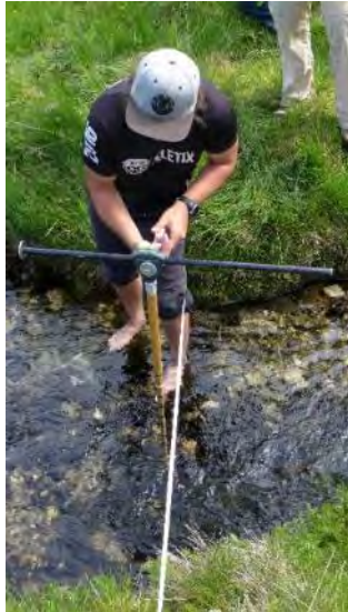
Abbildung 2. Messung der mittleren Strömungsgeschwindigkeiten entlang eines Querschnitts des Gewässers (links). Foto: Elisabeth Hainzer, DI (2017). Zur dauerhaften Abflussabschätzung im Gewässer wurden Druckpegel (HOBO U20-001-01, Onset, Bourne, Massachusetts) im Gewässer installiert (rechtes Bild). Neben Druckpegel werden auch Temperaturaufzeichnungen mittels Temperaturlogger (HOBO TidbiT v2, Onset, Bourne, Massachusetts) durchgeführt. Foto: Georg Niedrist.
