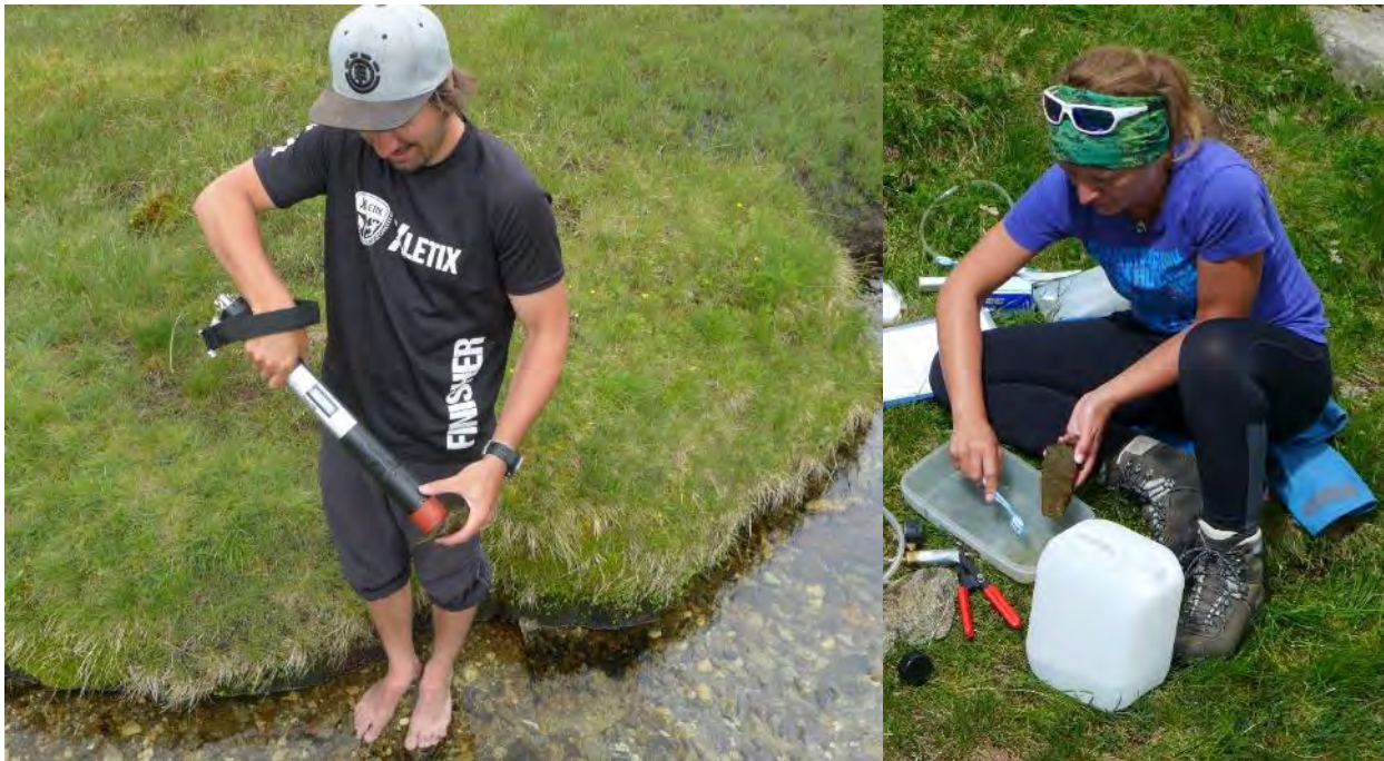
Abbildung 3. Im linken Bild wird mittels BenthoTorch (bbe moldaenke, Schwentimental, Deutschland) der Aufwuchs auf Steinen des Gewässergrundes analysiert. Dabei werden die Steine aus dem Wasser genommen, um zu verhindern, dass das Messgerät bei zu großen Wassertiefen beschädigt wird. Das Sonnenlicht wird ohnehin durch die Gummimanschette blockiert. Foto: Elisabeth Hainzer (2017) Zur Analyse des Chlorophyll- a Gehaltes und zur Analyse des organischen Materials im Aufwuchs werden im rechten Bild Steine mit 100ml Wasser abgebürstet. Zur späteren Analyse und Quantifizierung des abgebürsteten Materials im Labor wird es anschließend mittels Filtration auf Glasfaserfilter überführt. Foto: Elisabeth Hainzer (2017)
