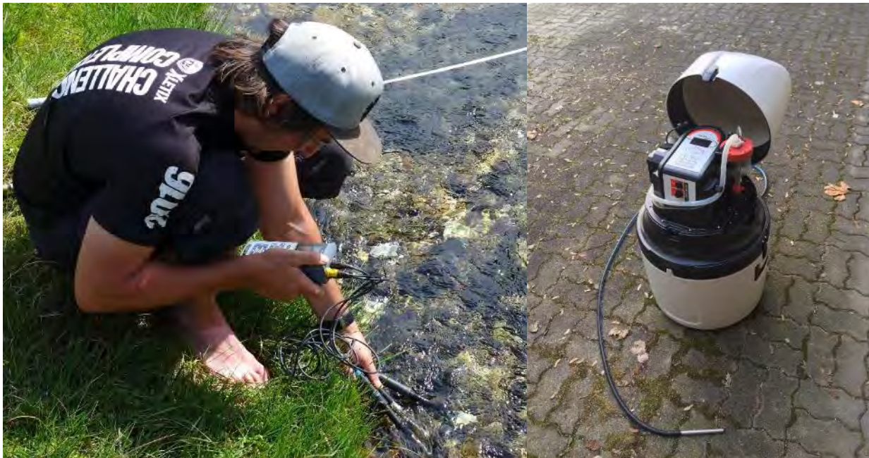
Abbildung 7. Im linken Bild wird die Wasserchemie mit einer Multisonde (WTW - Wissenschaftlich-Technische Werkstätten GmbH, Deutschland - MultiLine® 3430: digitale pH-Elektrode SenTix® 940, digitale Leitfähigkeitsmesszelle TetraCon® 925, optischer Sauerstoffsensoren FDO® 925) aufgenommen. Im rechten Bild ist der verwendete Autosampler und seine Einsaugvorrichtung (P6 L, MAXX Mess- und Probenahmetechnik GmbH, Rangendingen) abgebildet.
