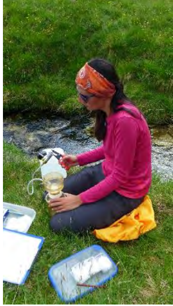
Abbildung 4. Mit Handpumpe und Filtrationsturm werden anorganische und organische Trübstoffe im Wasser quantifiziert. Foto: Elisabeth Hainzer (2017), im Bild: Ines Hrabie, MSc.
