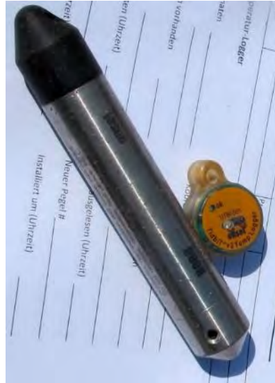
Abbildung 2. Messung der mittleren Strömungsgeschwindigkeiten entlang eines Querschnitts des Gewässers (links). Foto: Elisabeth Hainzer, DI (2017). Zur dauerhaften Abflussabschätzung im Gewässer wurden Druckpegel (HOBO U20-001-01, Onset, Bourne, Massachusetts) im Gewässer installiert (rechtes Bild). Neben Druckpegel werden auch Temperaturaufzeichnungen mittels Temperaturlogger (HOBO TidbiT v2, Onset, Bourne, Massachusetts) durchgeführt. Foto: Georg Niedrist.
