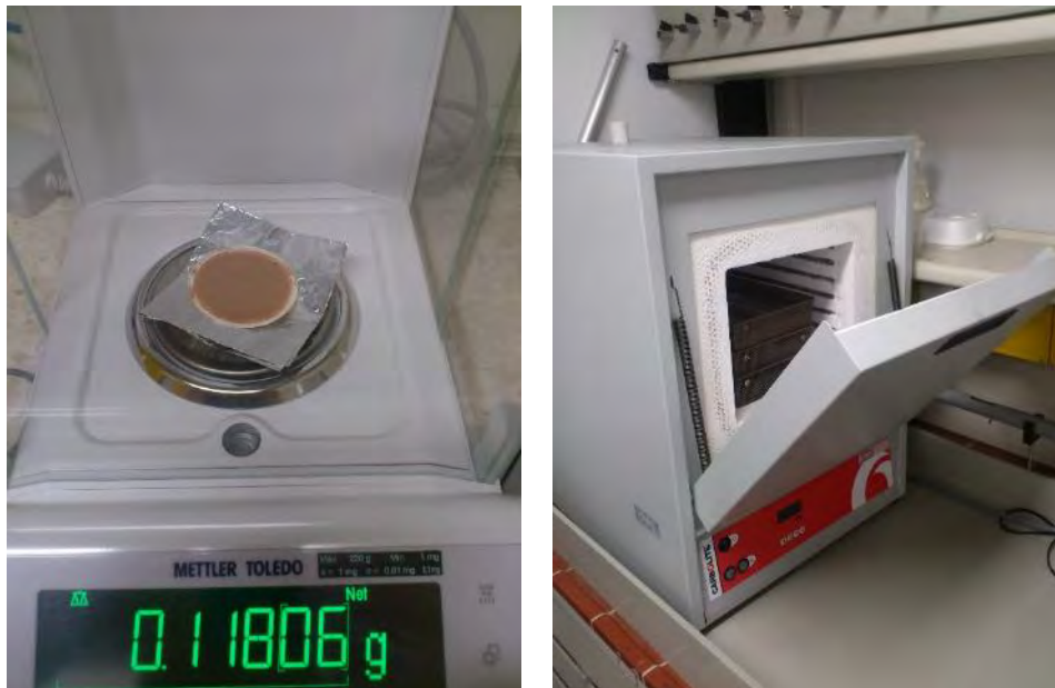
Abbildung 6. Das linke Bild zeigt die Präzisionswaage, mit der die Glasfaserfilter gewogen werden. Im rechten Bild ist der Muffelofen (Typ ELF 11/23 - Carbolite Gero GmbH & Co. KG, 75242 Neuhausen, Deutschland), mit dem sämtliches organisches Material auf den Filtern verbrannt wird, zu sehen.
