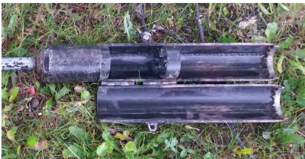
Abbildung 5: Bodenstecher aufgeklappt, eingeschweißter Begrenzungsring zur Aufnahme 3 Probenröhrchen
