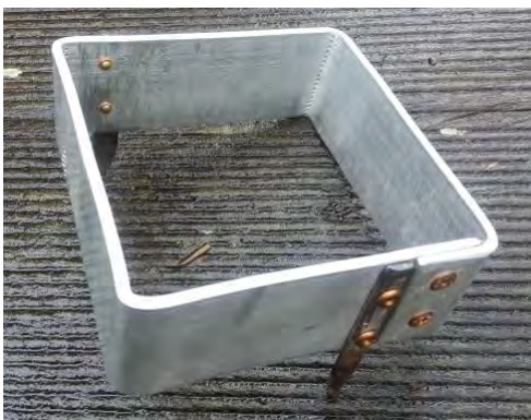
Abbildung 2: Metallrahmen zur Begrenzung der abzusaugenden Fläche
