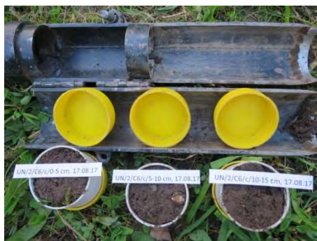
Abbildung 18 und 19: Eingestochener Bodenstecher, Bodenproben mit Beschriftungszettel und Verschlusskappen
