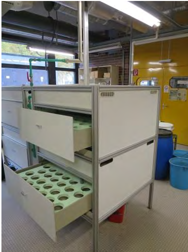
Abbildung 9: Modifizierter Macfadyen High Gradient Extraktor, Eigenkonstruktion am Institut f. Ökologie der Universität Innsbruck
