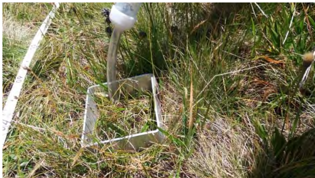
Abbildung 16: Absaugen der durch den Metallrahmen umgrenzten Fläche mit dem Mini-Handstaubsauger
