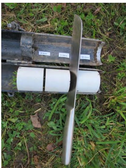
Abbildung 6: Aufgeklappter Bodenstecher mit ausgestochendem Bodenzylinder, Messer zur Durchtrennung der Tiefenfraktionen, Beschriftungszettel.
