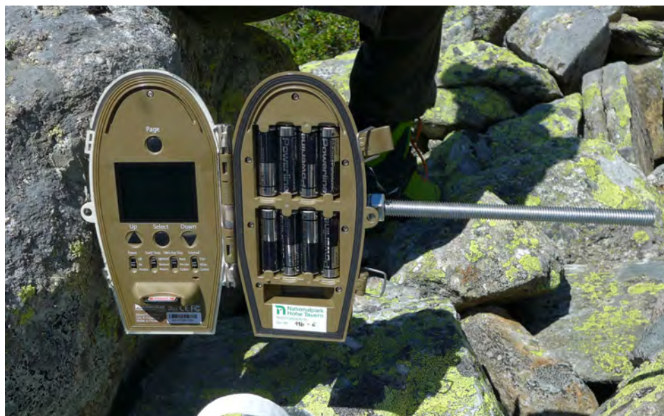
Abbildung 52: Beim Batterie- und SD-Kartentausch die Kamera auf der Aufhängung öffnen, Schalter Power auf "Off" und den Wechsel durchführen. Dabei darauf achten, dass die Kameraposition nicht verändert wird.
