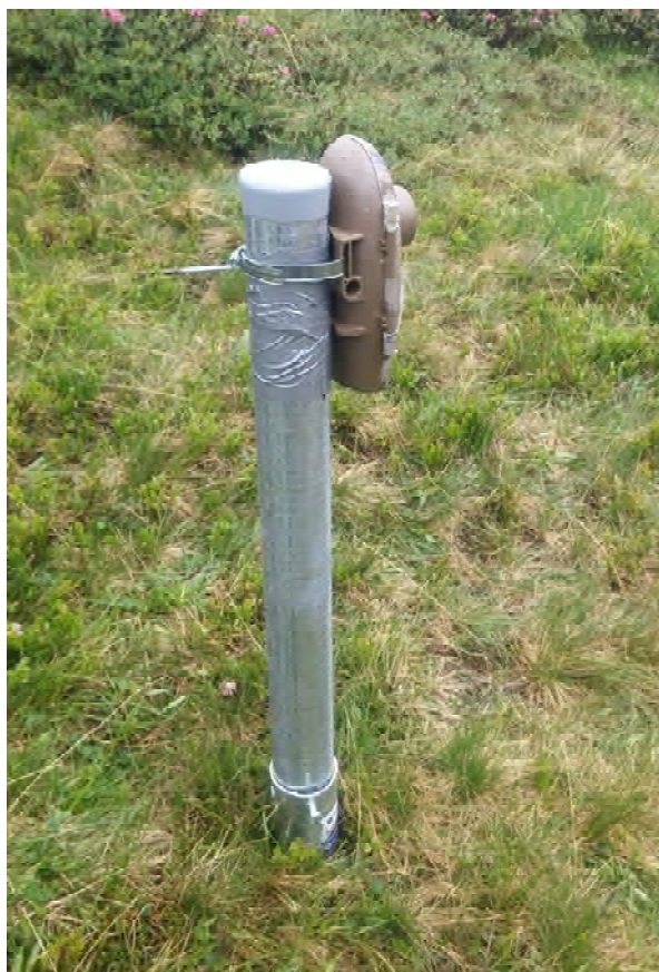
Abbildung 44: Montierte Kamera mit Schlauchschelle auf Rundprofilstange, in grau gewellt dahinter befindet sich ein Gewebeklebeband gegen ein Verrutschen; Kamera IN4
