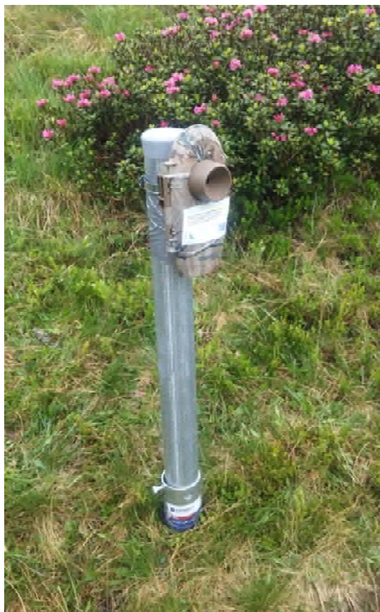
Abbildung 44: Montierte Kamera mit Schlauchschelle auf Rundprofilstange, in grau gewellt dahinter befindet sich ein Gewebeklebeband gegen ein Verrutschen; Kamera IN4
