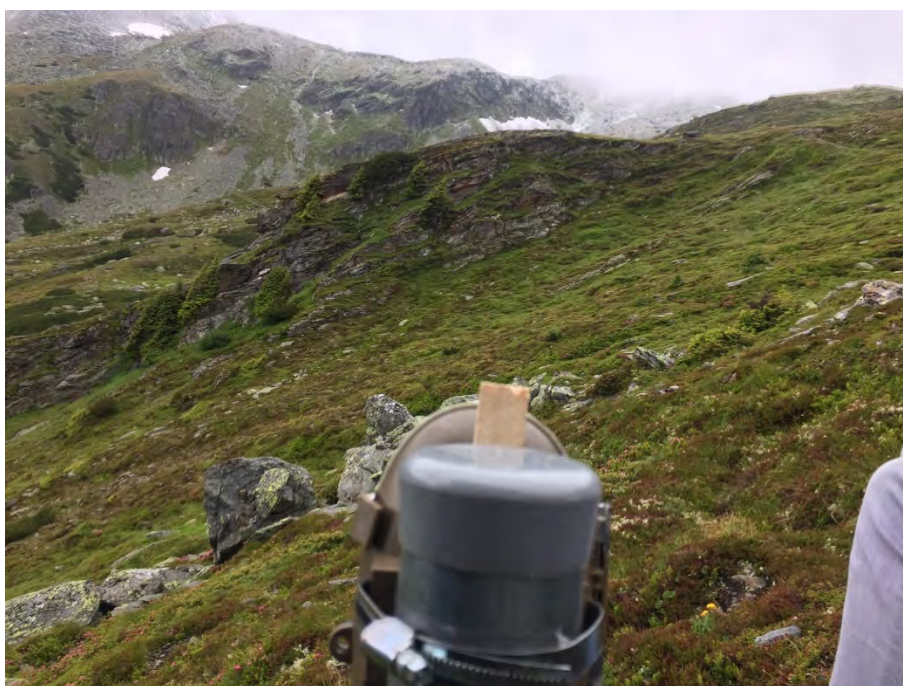
Abbildung 45: Ein Holzkeil wird zur Anpassung der vertikalen Ausrichtung zwischen Rundrohr und Kamera eingeschoben und mit dem Gewebeklebeband am Rundrohr gegen Verrutschen befestigt. Kamera SE4
