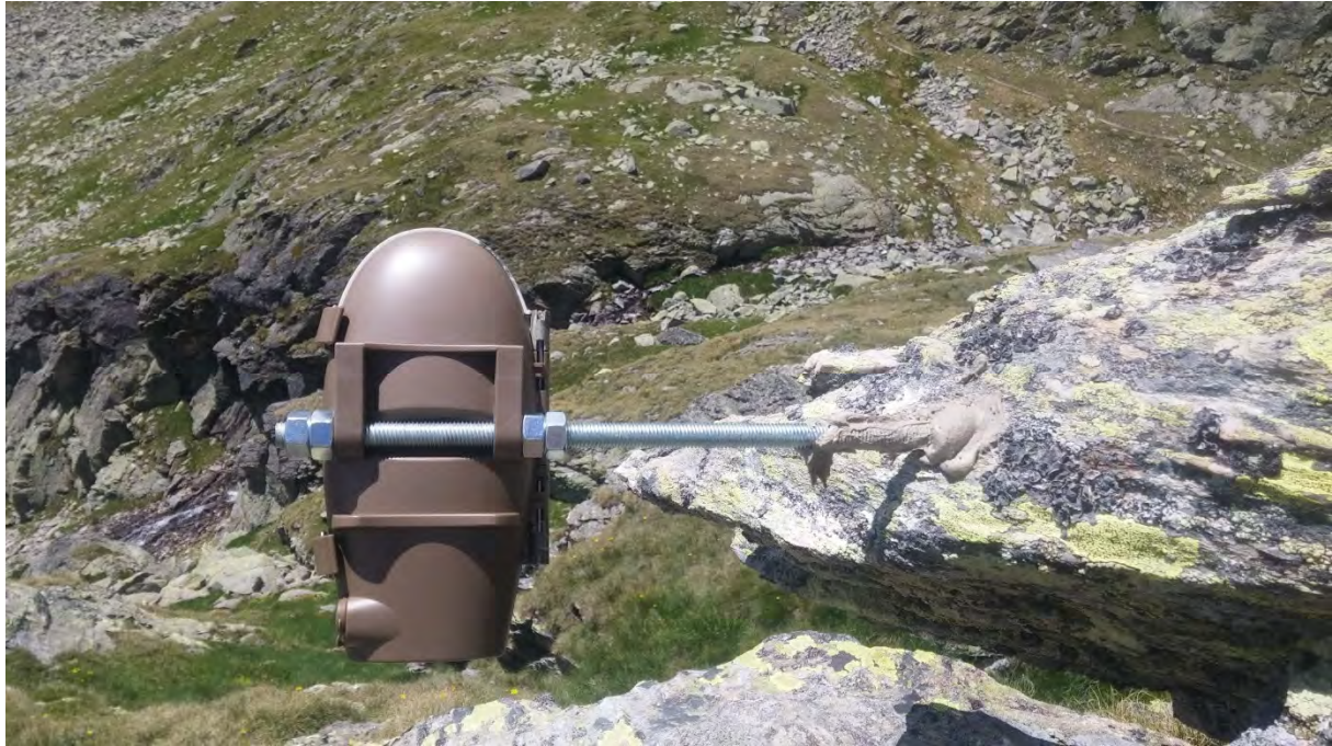
Abbildung 46: Auf einer in den Stein geklebten Gewindestange befestigte Kamera. Ausrichtung und Fixierung der Kamera mit Sechskantmuttern und Schraubenschlüssel 19; die festverschraubten innenliegenden Sechskantmuttern geben die horizontale Position der Kamera an, mit den außenliegenden Sechskantmuttern wird die Kamera in der richtigen Position festgeschraubt; Kamera SE9
