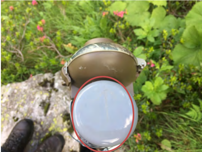
Abbildung 43: Pfeil an der Plastikcappe (mit rotem Kreis im Bild markiert; etwas schwer erkenntlich am Bild) zeigt die horizontale Ausrichtung für die Kamerainstallation an
