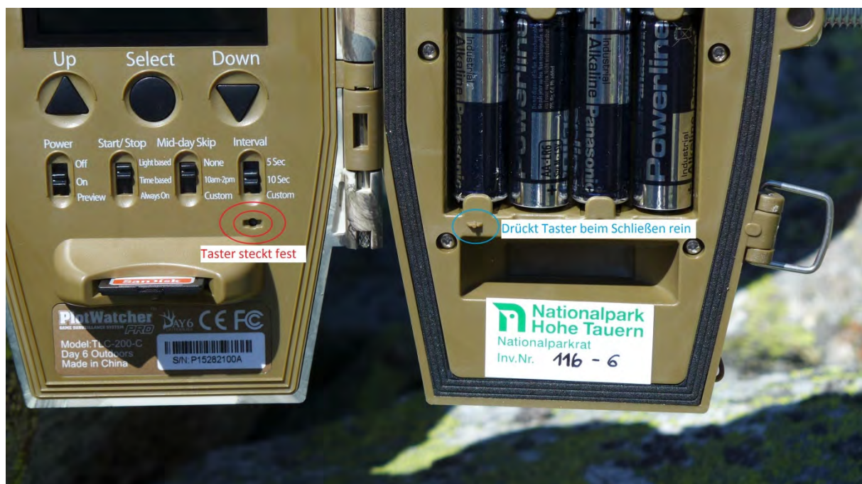
Abbildung 51: Taster (roter Kreis) zur Aktivierung des LCD-Displays für Einstellungen. Dieser bleibt bei einigen Kameras nach dem Öffnen der Kamera im Case stecken und muss mit Hilfe einer Sicherheitsnadel gelöst werden. Erst wenn der Taster herauskommt, wird das Display für die Einstellungen bzw. das Previewbild angezeigt.
