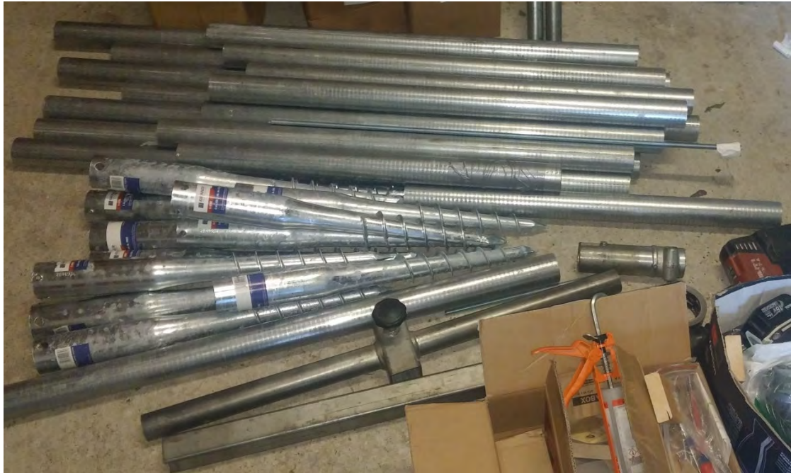
Abbildung 40: Material für Bodenverankerungstechnik: Oben 6 cm Rundrohre Länge 1,2 m; darunter Erdnägel ca. 50cm lang, darunter zerlegter T-Schlüssel der Wegebauer
