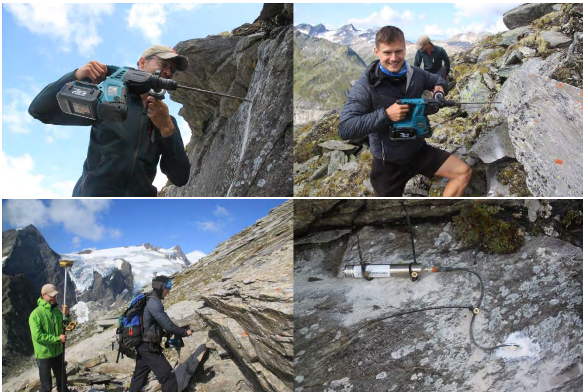
Abbildung 7: Bohraktivitäten an den drei Felslogger-Standorten am Inneren Knorrkogel. Oben links – Standort Flanke-Felslogger-NE; oben rechts – Standort Flanke-Felslogger-W; unten links – Standort Flanke-Felslogger-S; unten rechts – fertig installierter 3-Kanaldatenlogger am Standort Flanke-Felslogger-NE mit Messensoren in 3, 10 und 40 cm Tiefe. (Fotos: A. Kellerer-Pirklbauer)
