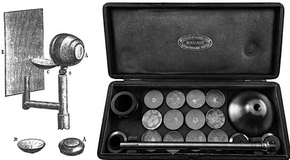
Abb. 2: Links: Oberer Teil des Ophthalmoskopierphantoms nach Perrin der Firma Nachet, in: Perrin, Description , wie Anm. 8, 3. Rechts: Bestandteile des Modells nach Perrin der Firma Mariaud in Schatulle (Foto: Beate Kunst)
