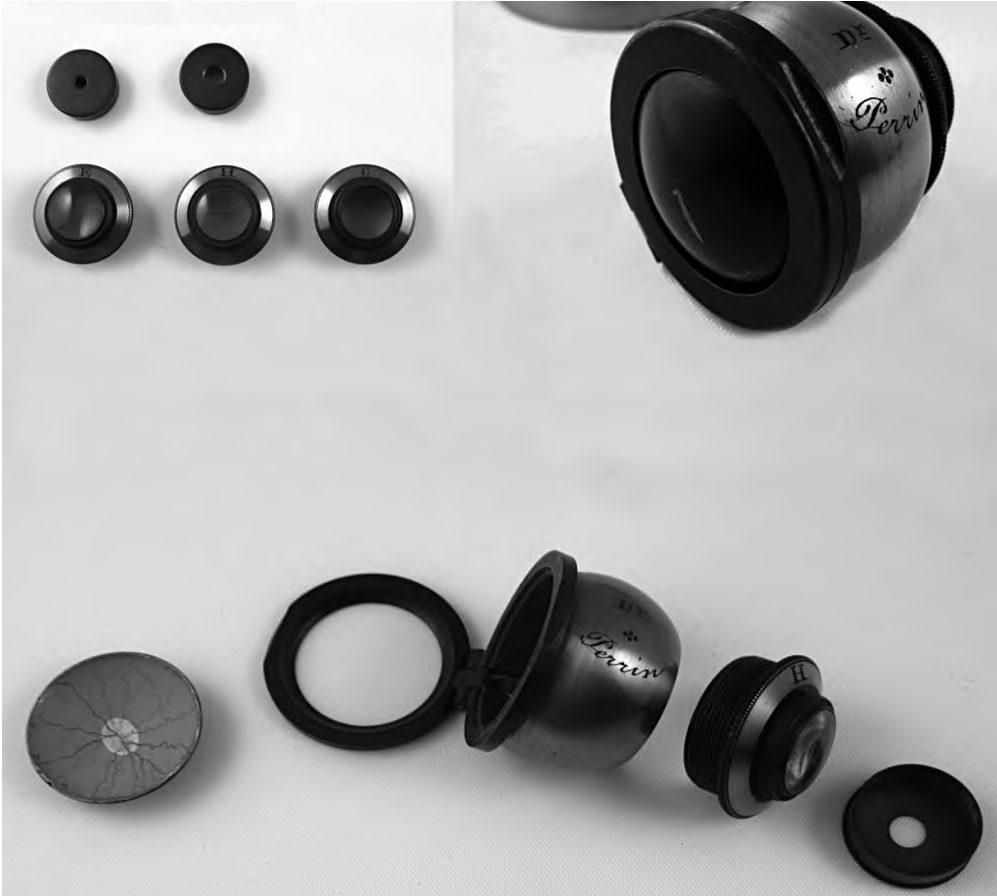
Abb. 4: Modell von Perrin der Firma Mariaud: Oben links die drei verschiedenen Linsen und die beiden Diaphragmen, oben rechts das fertig zusammengesetzte Auge, unten seine einzelnen Bestandteile (Foto: Beate Kunst)
