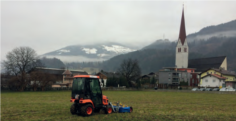
Abb. 6. Volders, Harbfeld: Messungen mit dem motorisierten Bodenradarsystem MIRA 1 im März 2017 (Foto: R. Filzwieser).
