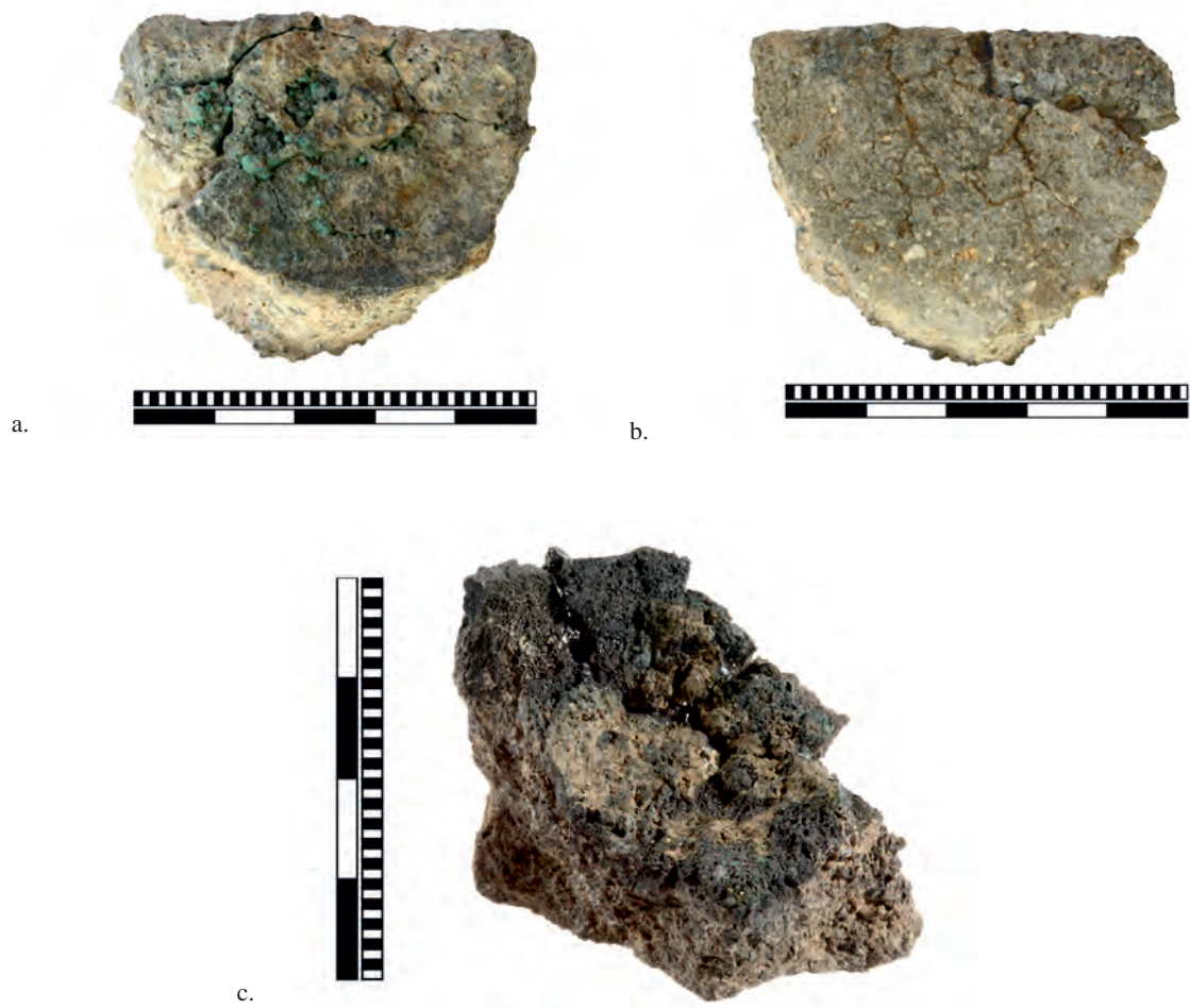
Taf. 55 Tiegelfragmente aus den Schnitten S1–4, M = 1:1: a. Verschlackte Innenseite (Kat. Nr. 206); b. Unverschlackte Außenseite (Kat. Nr. 206); c. Bodenfragment des Tiegels mit verschlackter Innenfläche (Kat. Nr. 213) (Fotos: M. Mehofer)
