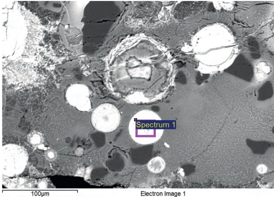
Abb. 28 REM-Aufnahme von korrodierten Arsenkupfereinschlüssen: Spektrum 1 zeigt 0,9% FeO; 93,8% CuO; 3,4% \text{As}_2\text{O}_3 und 2,9% PbO (M. Mehofer, VIAS)
