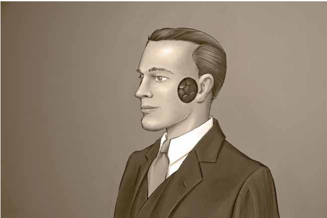
Abb. 1: Rekonstruktionszeichnung des frühen Kunstkopfmikrofons der Bell Telephone Company aus den Jahren 1931/32; Modellbezeichnung: Oscar (©Mario Valentinelli)
